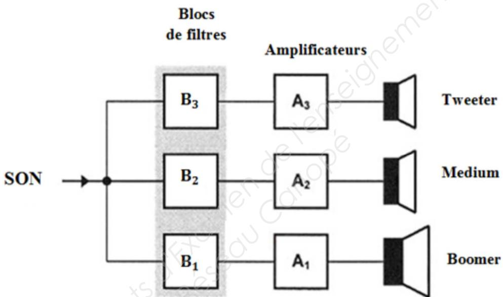
Dans l'exercice, on étudie un des blocs de filtres utilisés. Il est constitué de deux filtres  $F_1$  et  $F_2$ .
