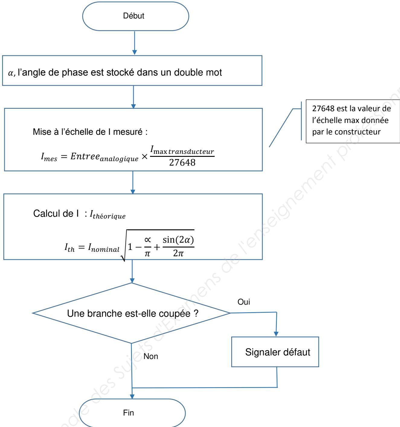
DTEC8 : Algorigramme décrit en « langage automate » pour la détection d'une branche coupée pour la zone 1 voûte
